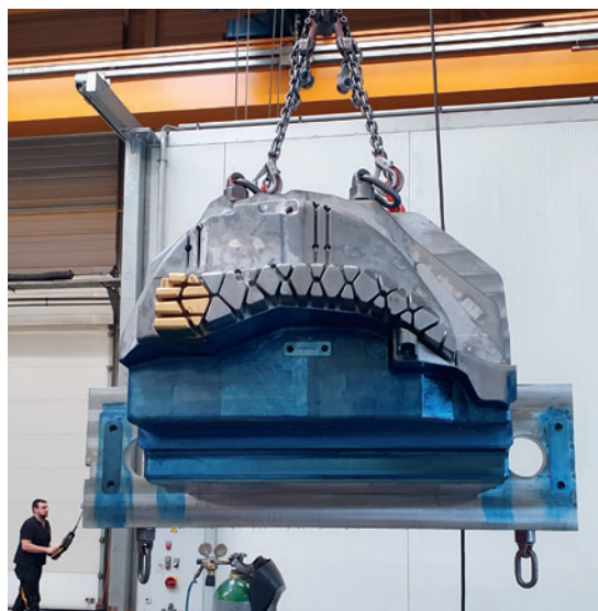
Eines von zwei formgebenden, je rund 7,5 Tonnen schweren Teilen einer Druckgussform für grosse Strukturteile von Elektroautos. Alles in allem wiegt die Form gut 130 Tonnen.
